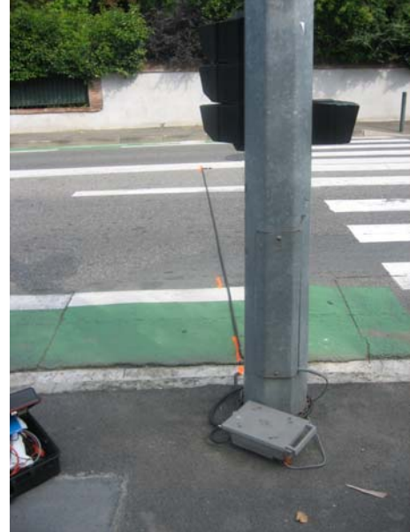
Figure 7 : Compteur CIGALE et tube pneumatique au droit du feu côté Tournefeuille
