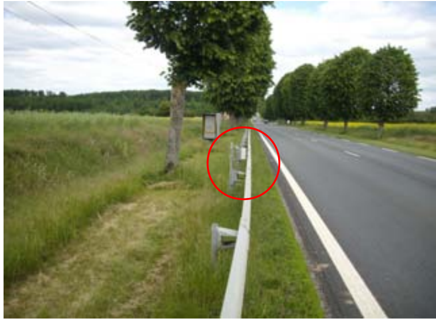
Exemple d'installation du VIKING (Il est placé sur l'accotement derrière une glissière de sécurité ou derrière un panneau de signalisation)
