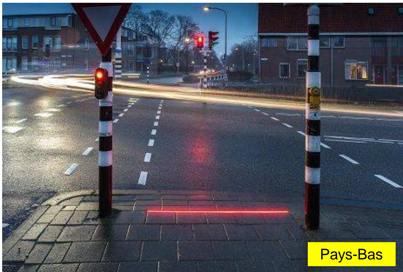
Réglète lumineuse d'alerte des piétons
