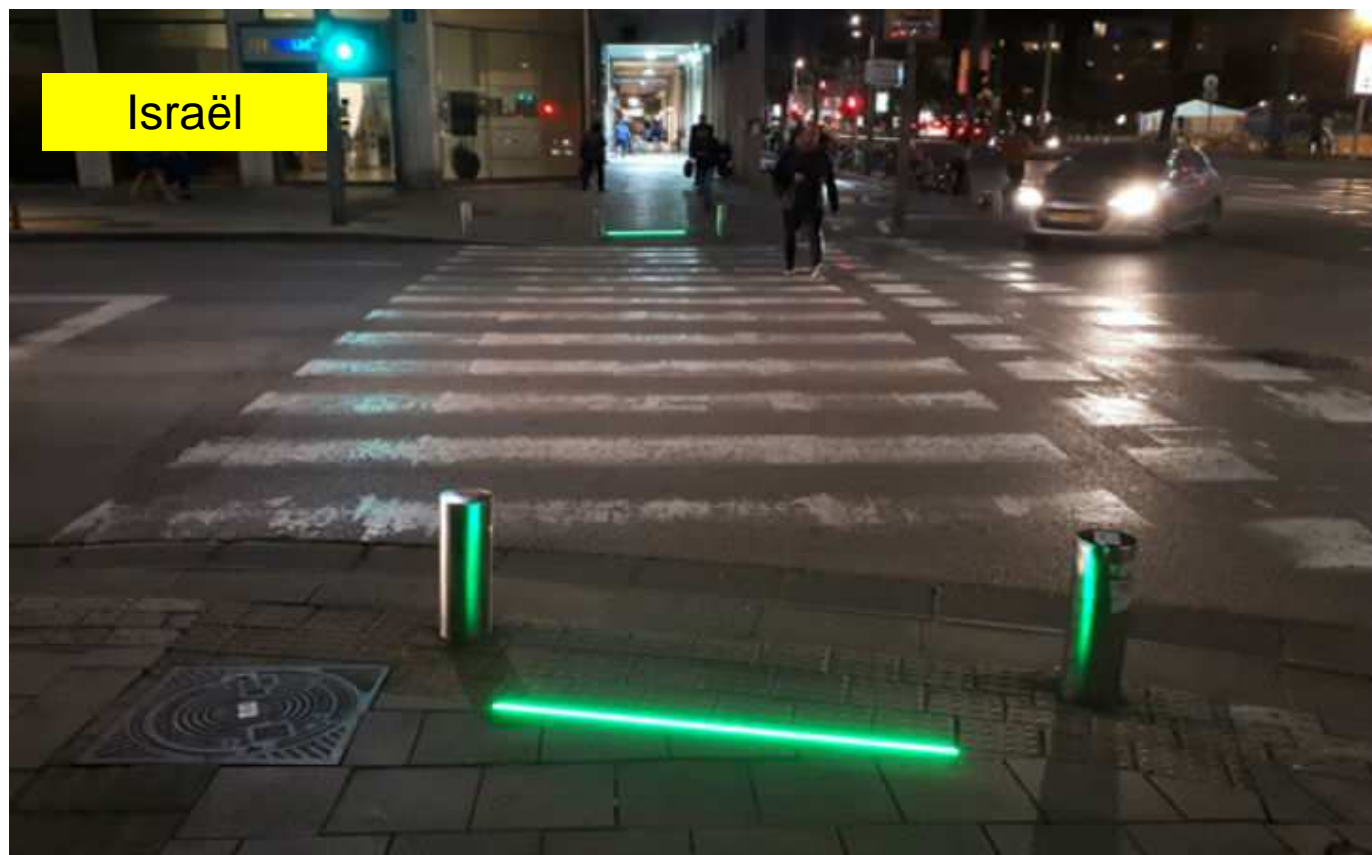
Réglète lumineuse d'alerte des piétons
