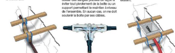
**Maintien à son niveau d'origine d'un ouvrage gaz le temps des travaux :**
