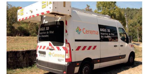
Aigle 3D permet l'auscultation des chaussées à grand rendement et en 3 Dimensions, et traite les données pour faciliter la planification des travaux d'entretien, grâce à un système de traitement de données de pointe.
