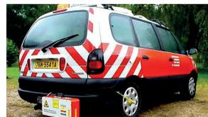
Rugo 2: Appareil de mesure de la Macrotexture et de la Mégatexture
