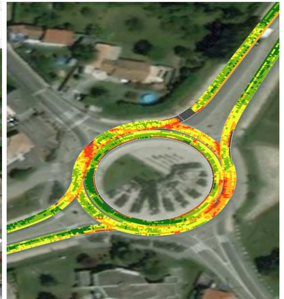
Représentation graphique de l'état de la chaussée par agrégation des données de fissuration collectées par Aigle 3D
