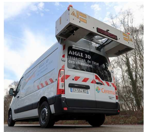
Véhicule Aigle 3D, inspection de l'état des chaussées
