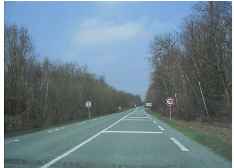
*Intersection RD913/RD143 : mise en œuvre d'une voie d'évitement et des bandes rugueuses associées à une limitation de vitesse à 70 km/h*
