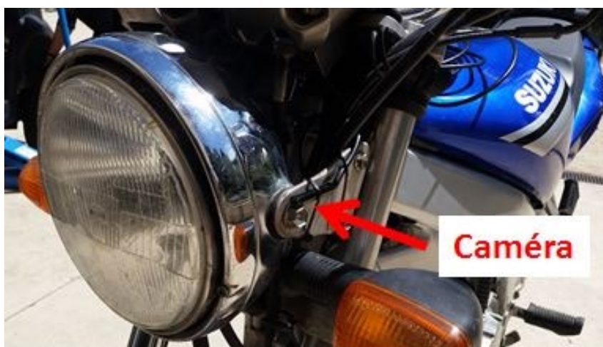
La caméra miniature filmant la scène routière sera fixée à l'avant du véhicule
