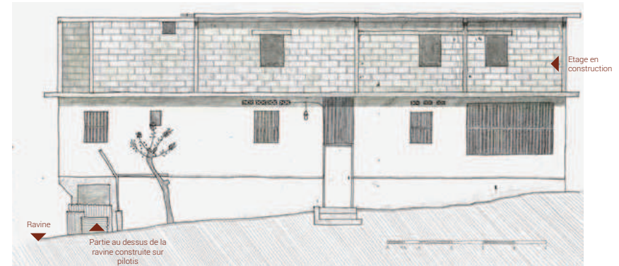
4. LOGEMENT EN PARPAING AVEC ÉTAGE EN CONSTRUCTION
