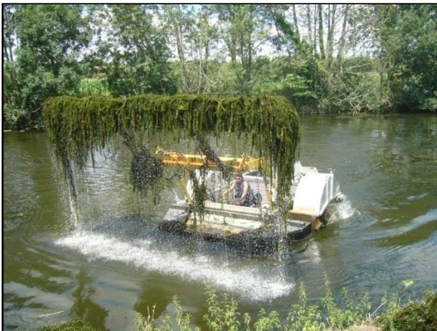
Arrachage mécanique de l'Egérie dense sur la Vendée à Fontenay le Comte (85)
