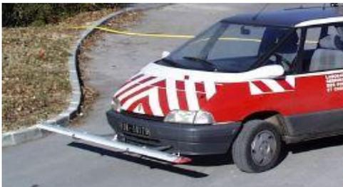
La règle et ses 13 capteurs à ultrason
