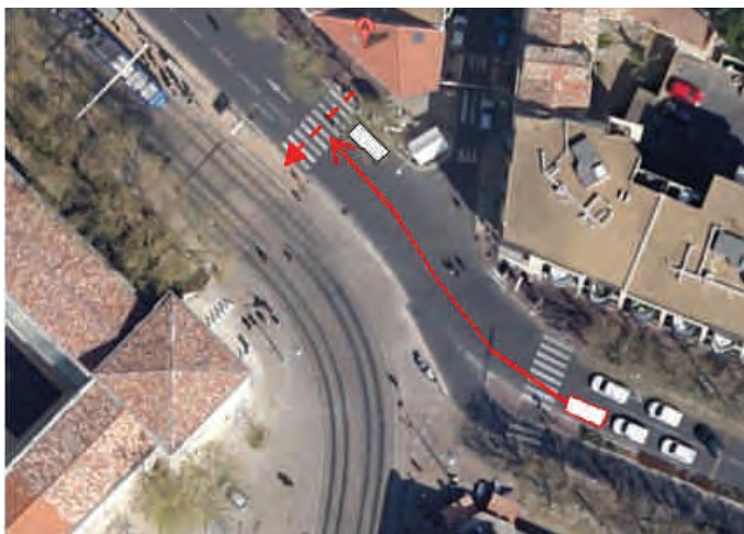
Illustration 10: Schéma d'accident avec un véhicule arrêté sur la première voie masquant le piéton aux véhicules de la seconde voie
