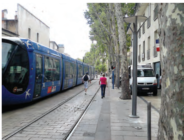
Illustration 5: Faible perception du Gabarit Limite d'Obstacle et de l'espace tramway (Crédit photo : Cerema)
