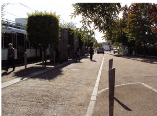
Illustration 12: Abri tramway et végétation créant un masque à la sortie de la station tramway (Crédit photo : Cerema)
