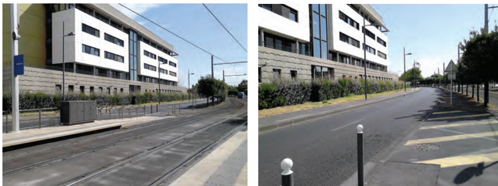
Illustration 14: Voies routières larges à sens unique incitant aux vitesses aux abords d'une station de tramway (Crédit photo : Cerema)
