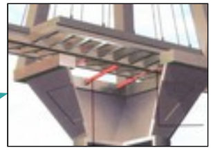
Fusibles installés sur le pont de Rion-Antirion (Grèce)
