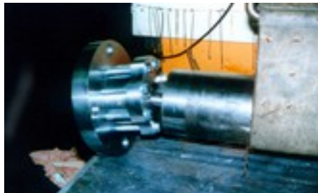
Photo 17: Extrémité de dispositif permettant les rotations dans les plans horizontal et vertical
