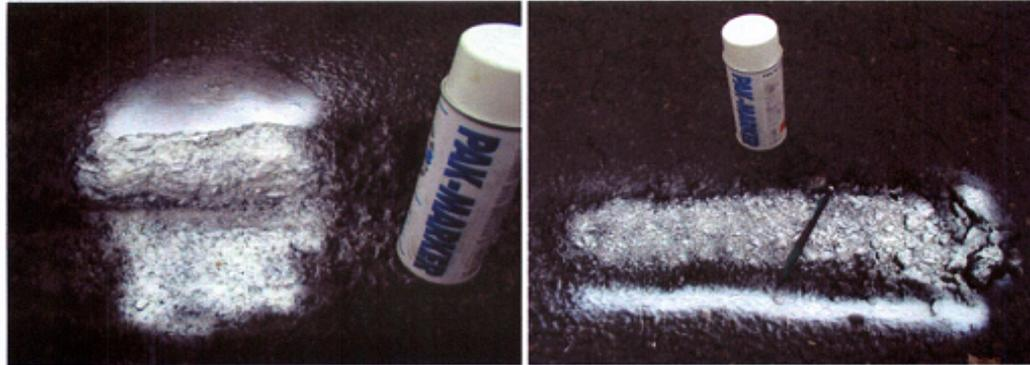
*Essais au PAK Marker sur des croûtes d'enrobés déposées en décharge*
