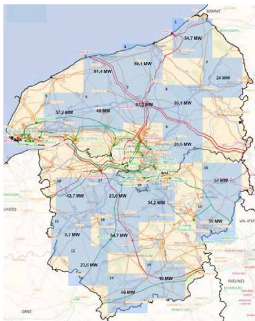
Gisement éolien en Haute-Normandie (chaque zone de gisement éolien est un secteur de 20 x 20 km) (source : S3REnR de Haute-Normandie)
