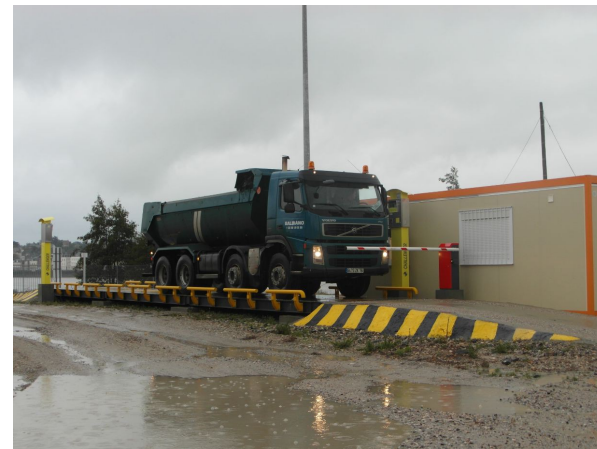
Pesée des camions en entrée/sortie
